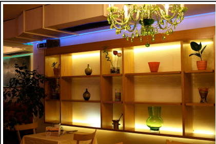
Raffinierte Lösung der Hintergrundbeleuchtung: LEDs in der Lüftung integriert.
